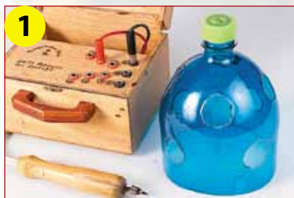
Con ayuda del pirógrafo abrir orificios.
